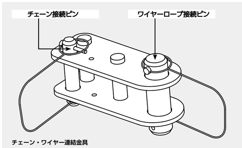
チェーン・ワイヤー連結金具は、ワイヤーロープを使用する場合に、QD専用吊りチェーンとワイヤーロープを接続できます。
