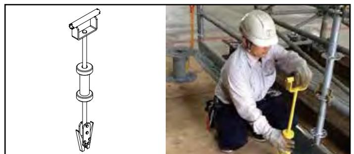
図5 - ノードピン引き抜き治具
