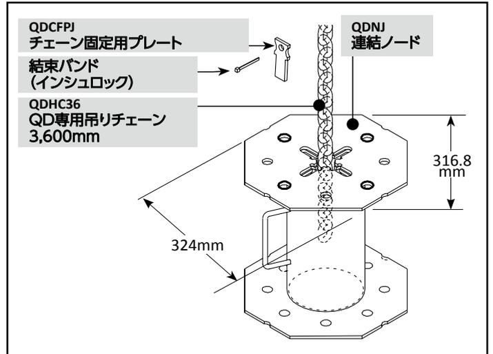
図3 - QD専用吊りチェーン3,600mmを連結ノードに結合
