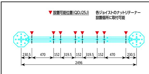
ジョイストは QuikDeck™ の第一の構造構成部品です。ジョイストは連結ノードと連結して、デッキサポートおよびデッキ材のための格子を形成します。
