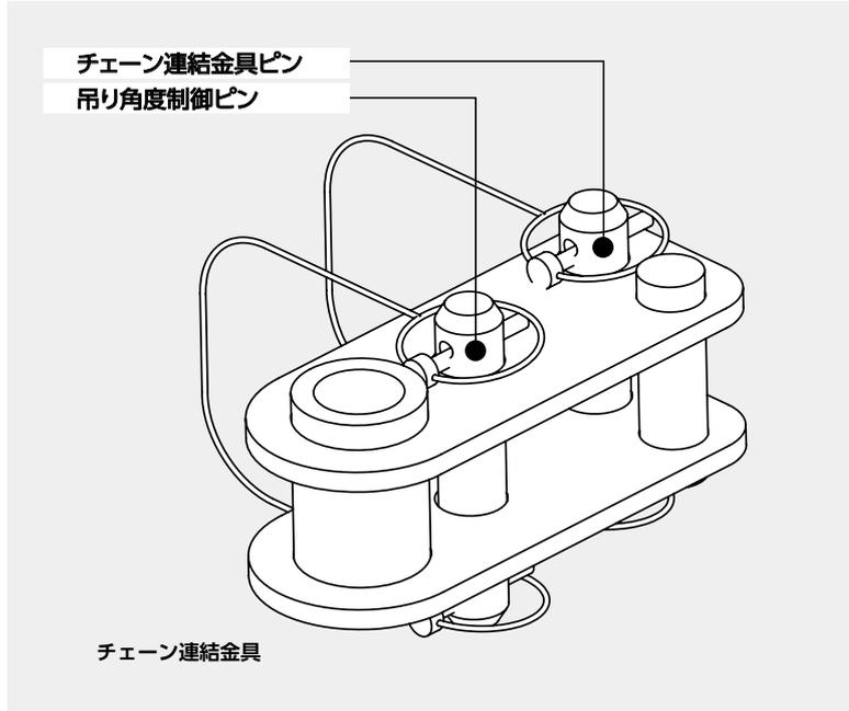
チェーン連結金具ピンは、専用吊りチェーンをチェーン連結金具に結合します。
